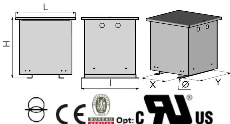
\*Les dimensions sont exprimées en millimètres, la masse en kilogramme et les réserves représentent l'espace de ventilation à conserver autour du produit pour une bonne dissipation thermique. Le schéma n'est pas contractuel.
